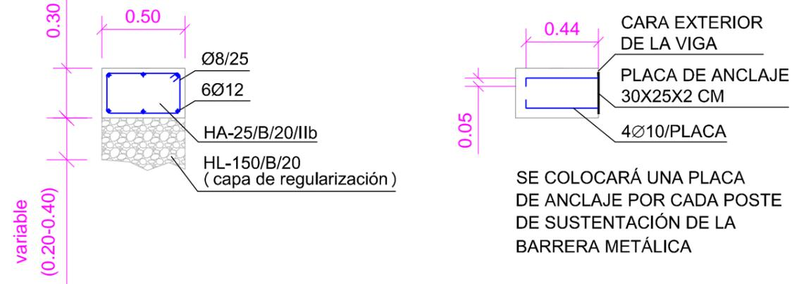
DETALLE DE VIGA DE ATADO DE HORMIGÓN ARMADO PARA CIMENTACIÓN DE BARRERA METÁLICA DE SEGURIDAD BMSNA4/T
