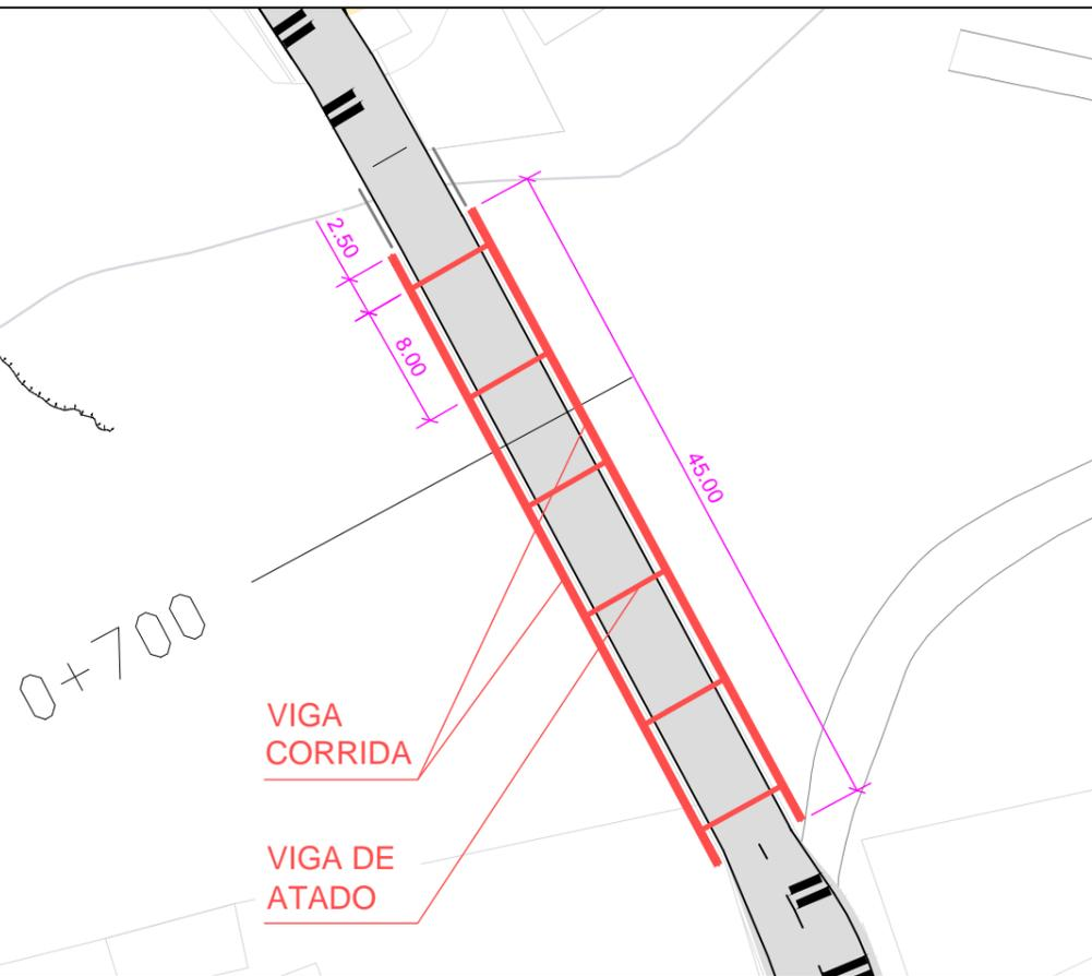
DETALLE DE VIGA CORRIDA DE HORMIGÓN ARMADO PARA CIMENTACIÓN DE BARRERA METÁLICA DE SEGURIDAD BMSNA4/T
