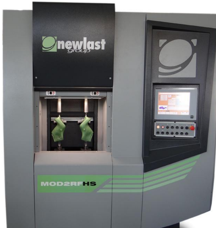
Centro mecanizado de hormas
